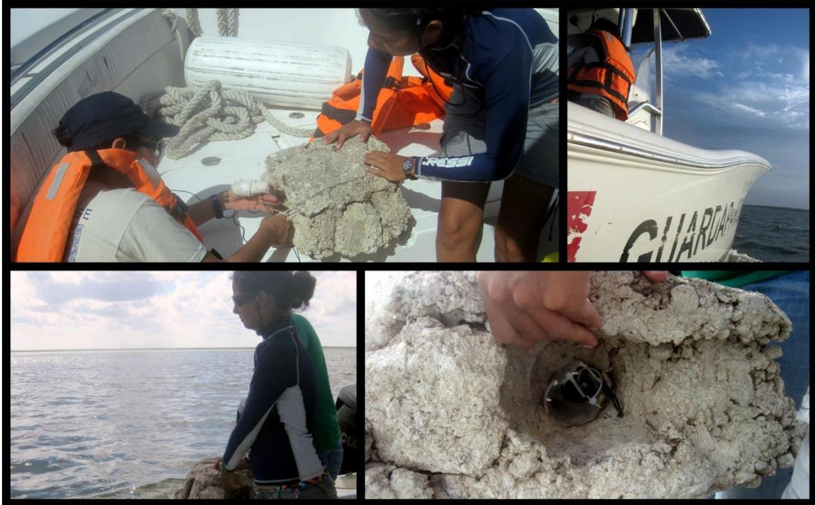
Figura 1. Instalación del sensor de temperatura y nivel del agua en Laguna Yalahau durante abril 2015.
