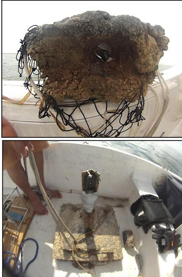
Figura 2. Estructura implementada para instalar sensor de temperatura y nivel de agua en el interior y boca de la Laguna Yalahau durante julio y agosto/septiembre 2015.
